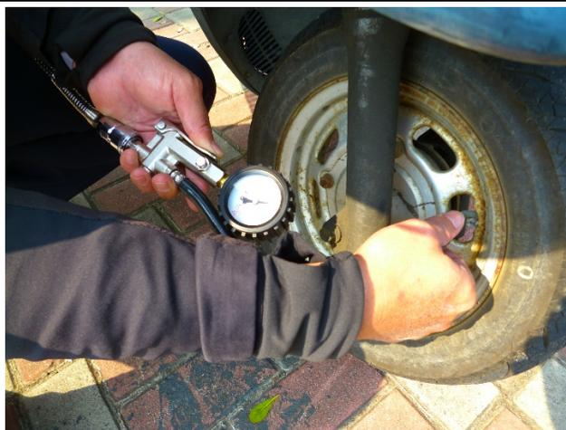
D. 壓住充氣板機 3-5 秒後放開，並檢查壓力表上之壓力，當胎壓達到機車使用手冊標示之胎壓值，即可停止供氣。(警告：不可一直壓住充氣板機(避免胎壓過大，而發生危險))。
